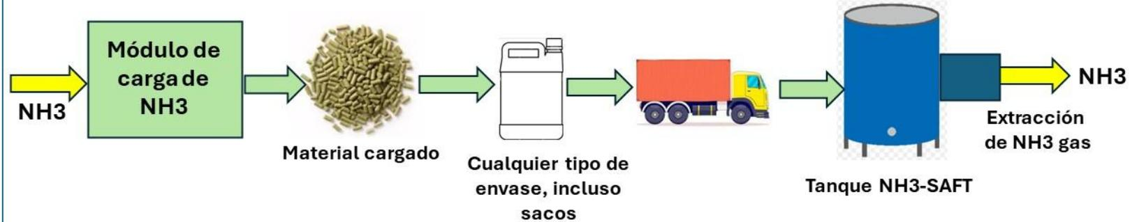
Modo de carga DIRECTA DE MATERIAL DE ESTADO SÓLIDO cargado en una estación de carga en instalaciones independientes
